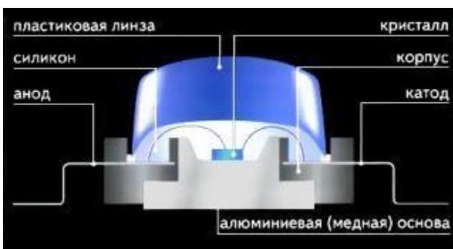
Работа светодиода основана на свойствах р-п или электронно-дырочного перехода, обусловленных взаимодействием двух полупроводников р-типа и н-типа: Р – positive, то есть положительный тип, или дырочный, и Н – negative, то есть отрицательный тип, или электронный. В результате пропускания электрического тока в месте соприкосновения двух полупроводников происходит переход от одного типа проводимости к другому, и мы видим излучение света.
