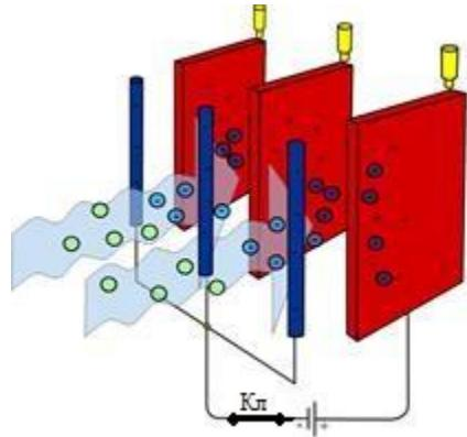
но представляет собой набор металлических пластин, между которыми натянуты металлические нити. Между нитями и пластинами создаётся разность потенциалов в несколько тысяч вольт, что приводит к образованию между ними сильного электрического поля и возникновению на поверхности нитей коронного разряда. В результате частицы пыли приобретают электрический заряд. Загрязнённый воздух подаётся в пространство между пластинами, заряженные частицы пыли под действием электрического
